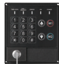
非常停止ボタン
